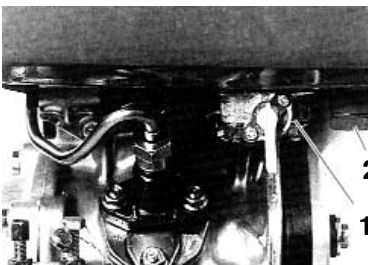
1- Гайка 2- Пробка слива топлива
